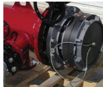
Manifold de 12" com 8 saídas de 6", 1 saída/entrada 12" e saída para canhão de 4"
