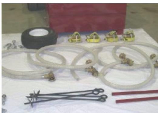
Material armazenado no baú removível: sistema proporcional, estepe e chave de rodas, adaptadores, derivantes (coletora (2.1/2") x 1(6") com retenção), estacas e martelo, etc.
