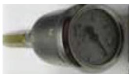
2. Ou aparafusando em um medidor de pressão de teste no lugar do existente.
