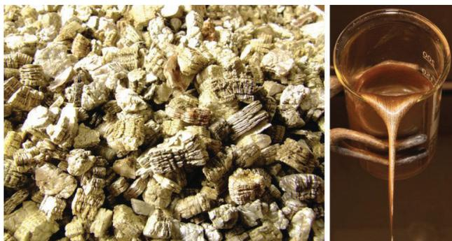
AVD é uma dispersão aquosa de vermiculita esfoliada quimicamente. É aplicado em incêndios de baterias de lítio na forma de névoa, extinguindo-os e evitando a propagação do fogo.
