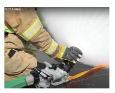
Acompanha este canhão monitor um esguicho Max-Force Dual Pressure, tratando-se de um esguicho de pressão balanceada que regula automaticamente a pressão de saída para 7 BAR ou 4 BAR (pressão de emergência), mantendo a velocidade de saída da água (pressão) permitindo mais estabilidade de alcance do monitor.
