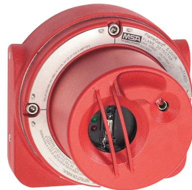
O Flamegard® 5 UV-IR é um detector inteligente e possui contato de relé para indicação remota da detecção de chama, permitindo sua utilização como unidade autônoma ou conectada a centrais de monitoração de incêndio em canais independentes ou ligados em cascata, para a otimização da instalação. Esse contato de relé só é acionado quando há a captação de radiações UV e ou IR em níveis acima dos pré-ajustados.
